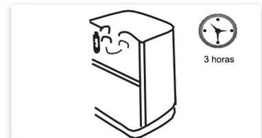
3. No guarde nada hasta que la temperatura dentro del frigobar baje lo suficiente (aproximadamente 2 horas).
